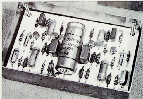
Bild 16. Ansicht des Entzerrer-Vorverstärkers mit Abschirmgehäuse
