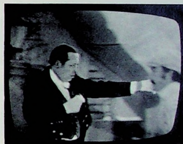
Bild 5. Bildschirmaufnahme mit 1/50 s Belichtungszeit (Schlitzverschlusskamera). Das Bild zeigt helle und dunkle Streifen; auf der Originalvergrößerung ist die Weiteiligkeit im dunklen Streifen — von der rechten unteren Ecke ausgehend — deutlich erkennbar. („Leica M 4“ mit „Elmarit“ 2,8/90 mm; Blende 8; Agfapan 1000 Professional)
